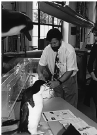
Dr. Bannasch, der Koordinator des Kompetenznetzes Bionik, bereitet einen Versuch vor. Messungen an „Pinguin“-Modellen sollen dazu dienen, den Strömungswiderstand an Flugzeugrümpfen zu verringern
