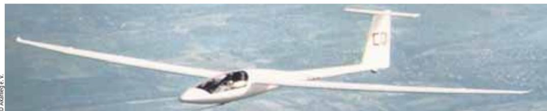
Er ist das Paradeprojekt des Akademischen Fliegervereins Akaflieg e. V.: der doppelstilige Motorsegler B13 mit einer Spannweite von 23,20 Metern, einer Länge von 8,55 Metern und einem Triebwerk in der Rumpfspitze. Fast alle an diesem Projekt Beteiligten sind TU-Studenten der Luft- und Raumfahrt.
