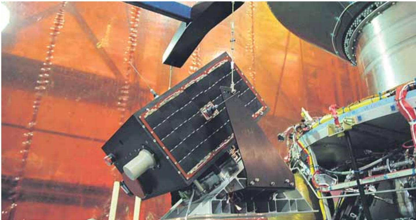
LAPAN-TUBSAT hat mit den Maßen 45 x 45 x 27 Zentimeter die Form eines abgeplatteten Würfels. Hier wird er auf die indische Trägerrakete montiert.
