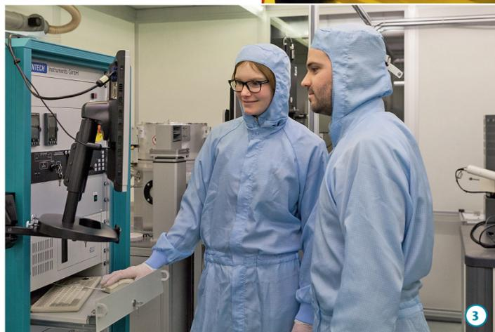
So vom Staube befreit, betritt man den ersten Bereich des Reinraums. Es ist der Aufdampfplasmaraum, an den sich der Nasschemieraum und der Lithografieraum anschließen. Die drei Bereiche haben eine Fläche von 130 Quadratmetern. Der Fußboden ist ein löchriges Gitter. Die Luft, mittels Feinfilter gereinigt, wird durch die Decke eingeleitet und durch die Löcher im Boden abgesaugt.
