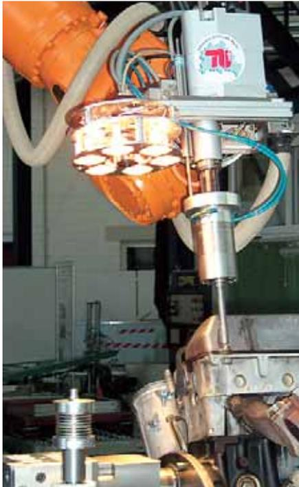
Entschraubungssystem mit Kamera und Sensor-feedback
