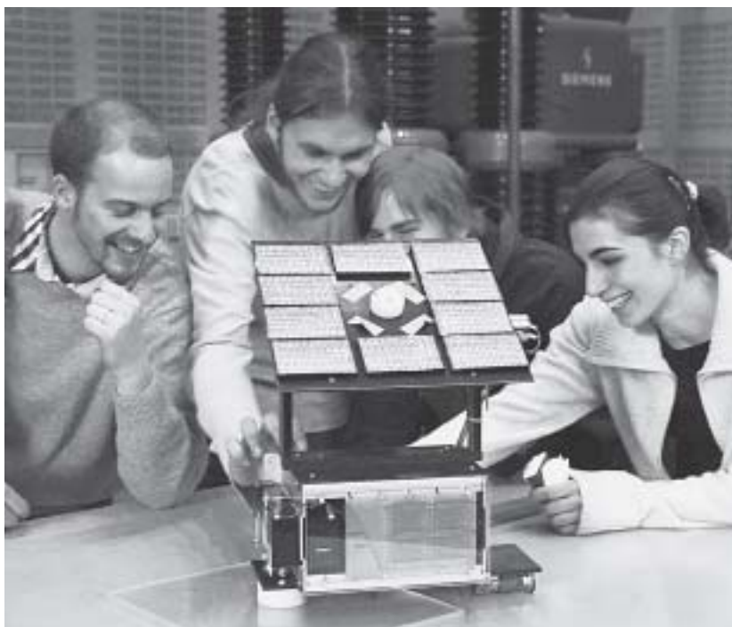
Da haben die Studierenden der Elektrotechnik gut gelacht: Ihr mit Solarzellen bestückter „Sonnenfinder“ hat sich im Labor planmäßig und selbstständig nach dem Licht ausgerichtet
