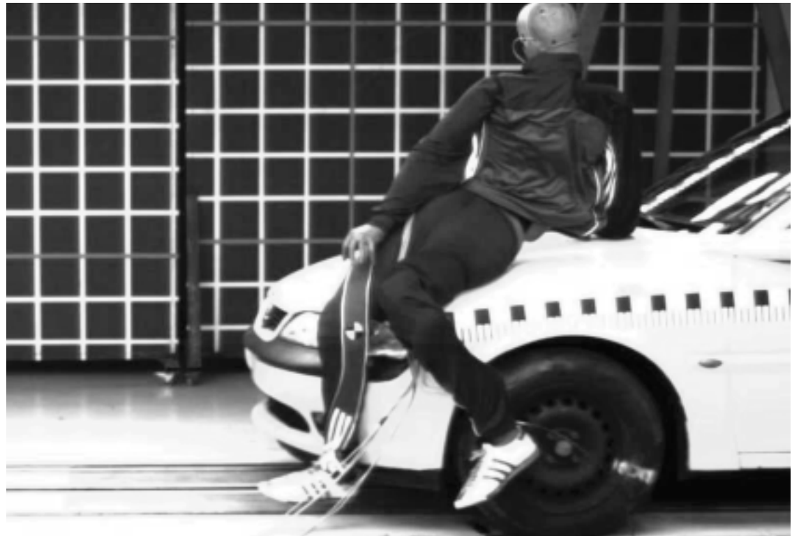
Crashsimulation mit Dummy: Dabei gewinnen die Wissenschaftler wertvolle Informationen auch über die beste Gestaltung der Fahrzeugfront
