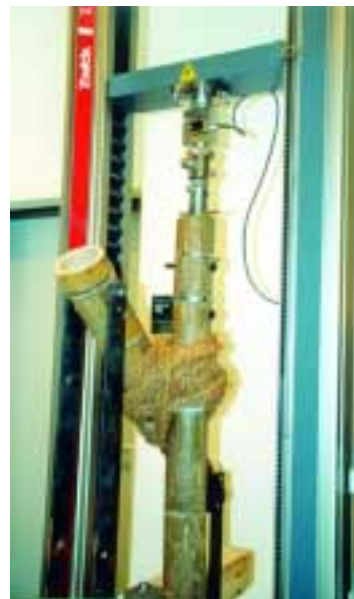
Die Verbindungen der Stangen auf dem Prüfstand in der TU Berlin
