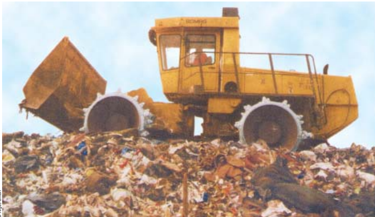
Ein so genannter Abfallkompaktor bei der Arbeit auf einer Mülldeponie
