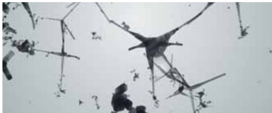
Bei der Kondensation von Zinkdampf entstandene Kristalle, betrachtet im hochauflösenden Transmissionselektronenmikroskop
