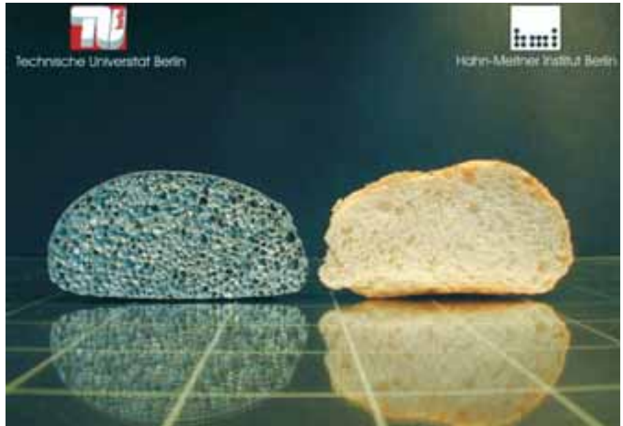
Nicht zum Reinbeißen: „frisch gebackener“ Metallschaum, links
