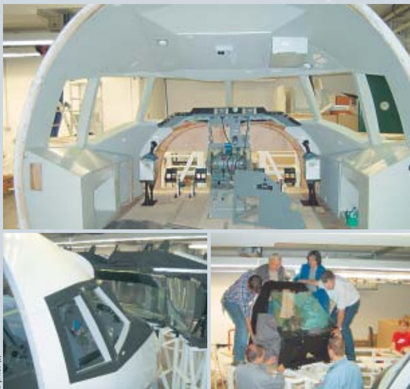
Werkstattmitarbeiter beim Aufbau der Cockpithülle und des Spiegelsystems im TU-Institut
