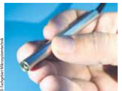
Kamera mit eingebautem Minimotor für die medizinische Anwendung
