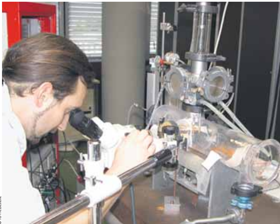
Physiker Raimund Kremzow, Mitglied der Arbeitsgruppe von Dr. Markus Pristovsek, blickt durch das Tunnelmikroskop. In der Kühlschleife werden die Proben von 800 auf 70 Grad Celsius heruntergekühlt
