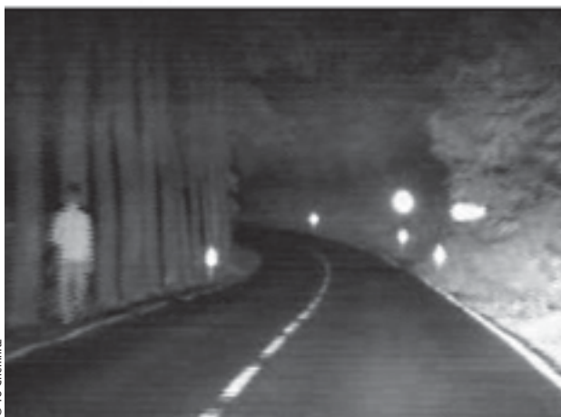
Moderne Nachtsichtsysteme mit Infrarot-Kameras liefern ein recht gutes Bild der Situation vor dem Fahrzeug. Oben eine Ferninfrarot-Aufnahme, unten eine mit einer Nahinfrarot-Kamera aufgenommene Szene
