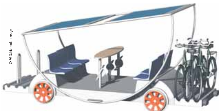
Modell der zukünftigen Solardraisine – mit Platz für Fahrräder
