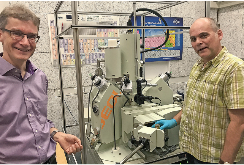
Dirk Berger (l.) und Jörg Nissen an der Feldemissions-Elektronenstrahlmikrosonde bei der Vorbereitung einer Messung. Die Apparatur umgibt ein Magnetfeldrahmen, um jegliche Störungen fernzuhalten, die den Elektronenstrahl ablenken. Schon die Verschiebung des Erdmagnetfelds durch einen in der Nähe vorbeifahrenden Lkw genügt, um die Analysen zu verfälschen
